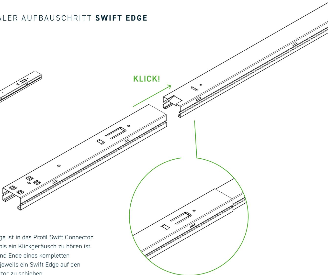
Der Swift Edge ist in das Profil Swift Connector zu schieben bis ein Klickgeräusch zu hören ist. Am Anfang und Ende eines kompletten Stranges ist jeweils ein Swift Edge auf den Swift Connector zu schieben.
