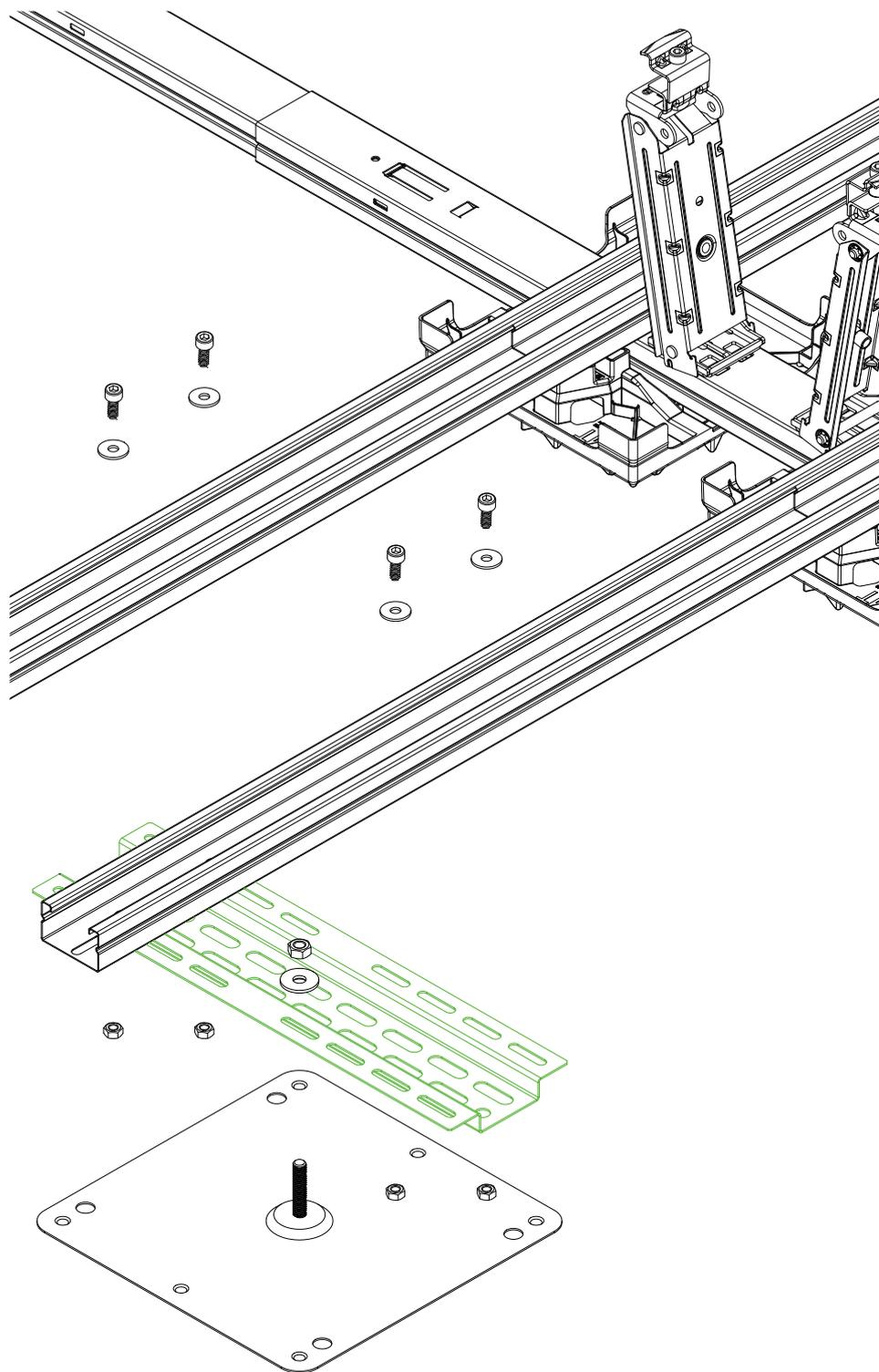
Die Befestigungspunkte der Stud Link-Anbindung befinden sich am Row Connector oder Row Link und sollten vor der Montage des Stud Link montiert sein. Die Befestigung der Stud Link-Anbindung sollte möglichst nah an einer Schiene erfolgen.
