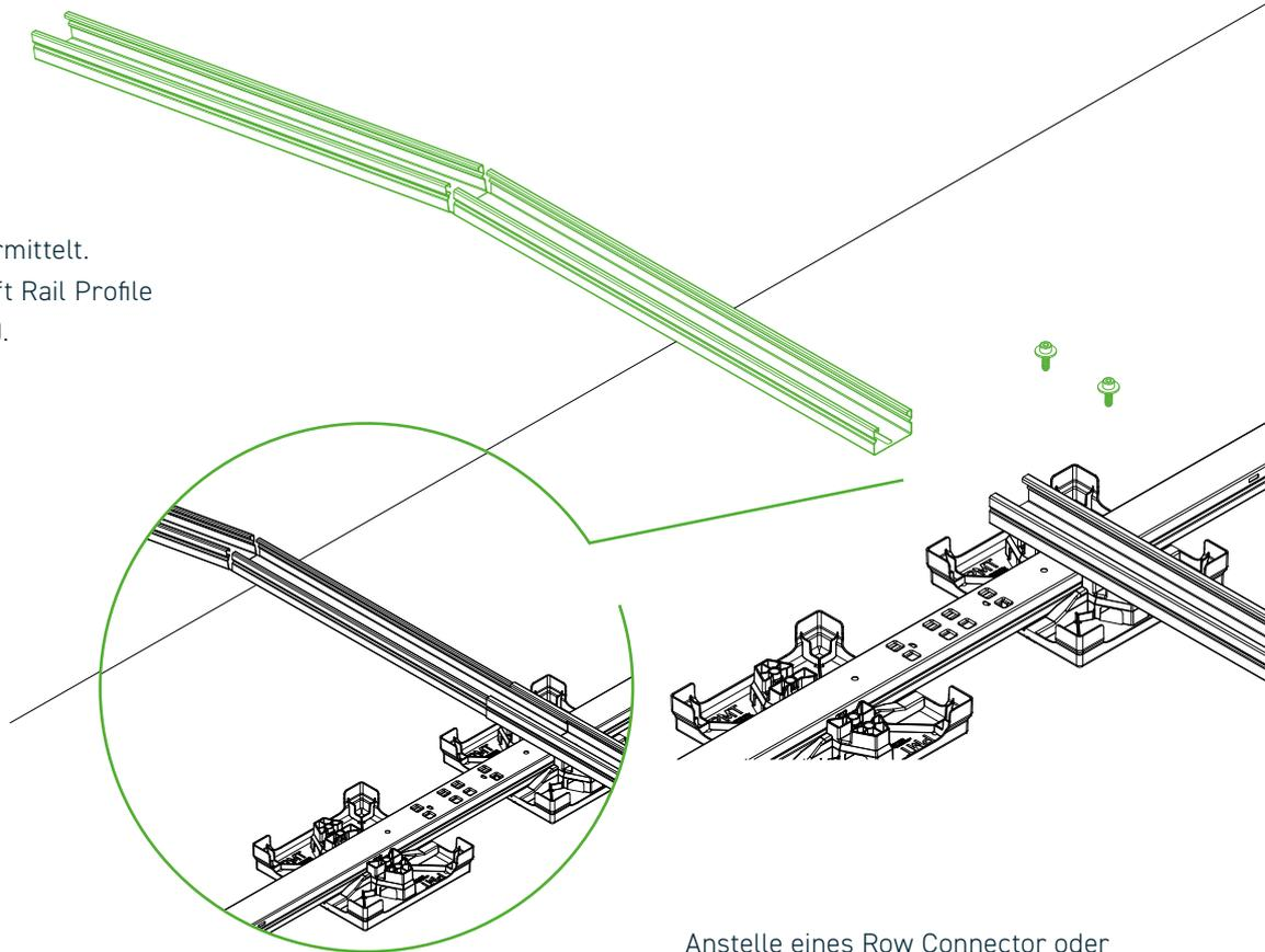
Anstelle eines Row Connector oder Row Link wird der Row Ridge eingebaut. Der Aufbau sollte gleichmäßig nach beiden Seiten erfolgen, um eine einseitige Belastung und somit ein Verrutschen zu verhindern. Die Lage und Position der Firstverbinder ist immer den aktuellen Projektunterlagen zu entnehmen.
