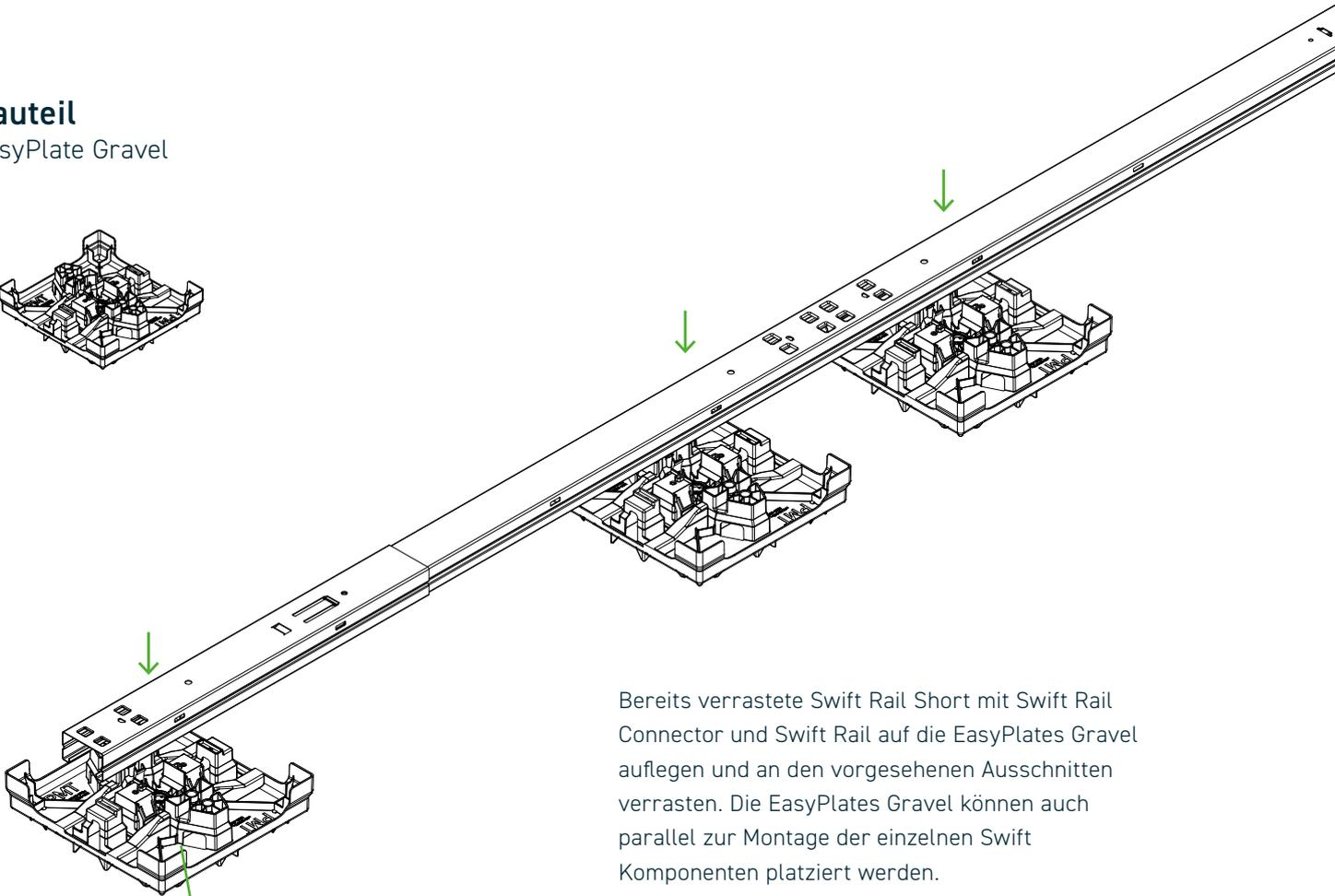
Bereits verrastete Swift Rail Short mit Swift Rail Connector und Swift Rail auf die EasyPlates Gravel auflegen und an den vorgesehenen Ausschnitten verrasten. Die EasyPlates Gravel können auch parallel zur Montage der einzelnen Swift Komponenten platziert werden.
