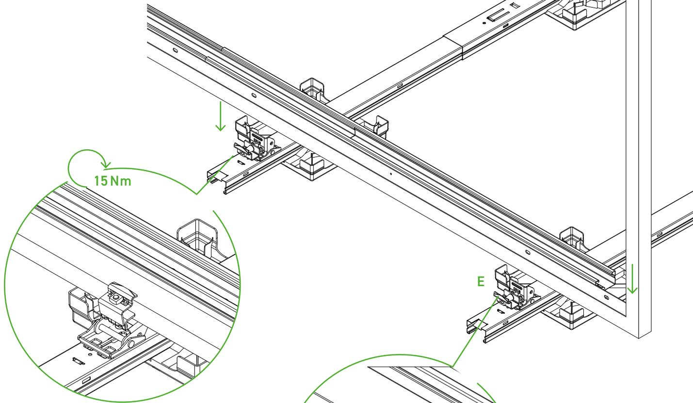
Pivot Single **E** in vertikale Position bringen und das Modul von oben in die Klemmen einlegen. Anschließend von hinten verschrauben und dabei auf festen Sitz und richtige Position überprüfen.
