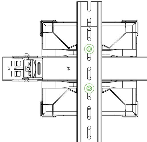
Row Connector Edge **H** und Row Link Edge **I** sind zwingend laut Projektbericht an den angegebenen Stellen zu montieren.
