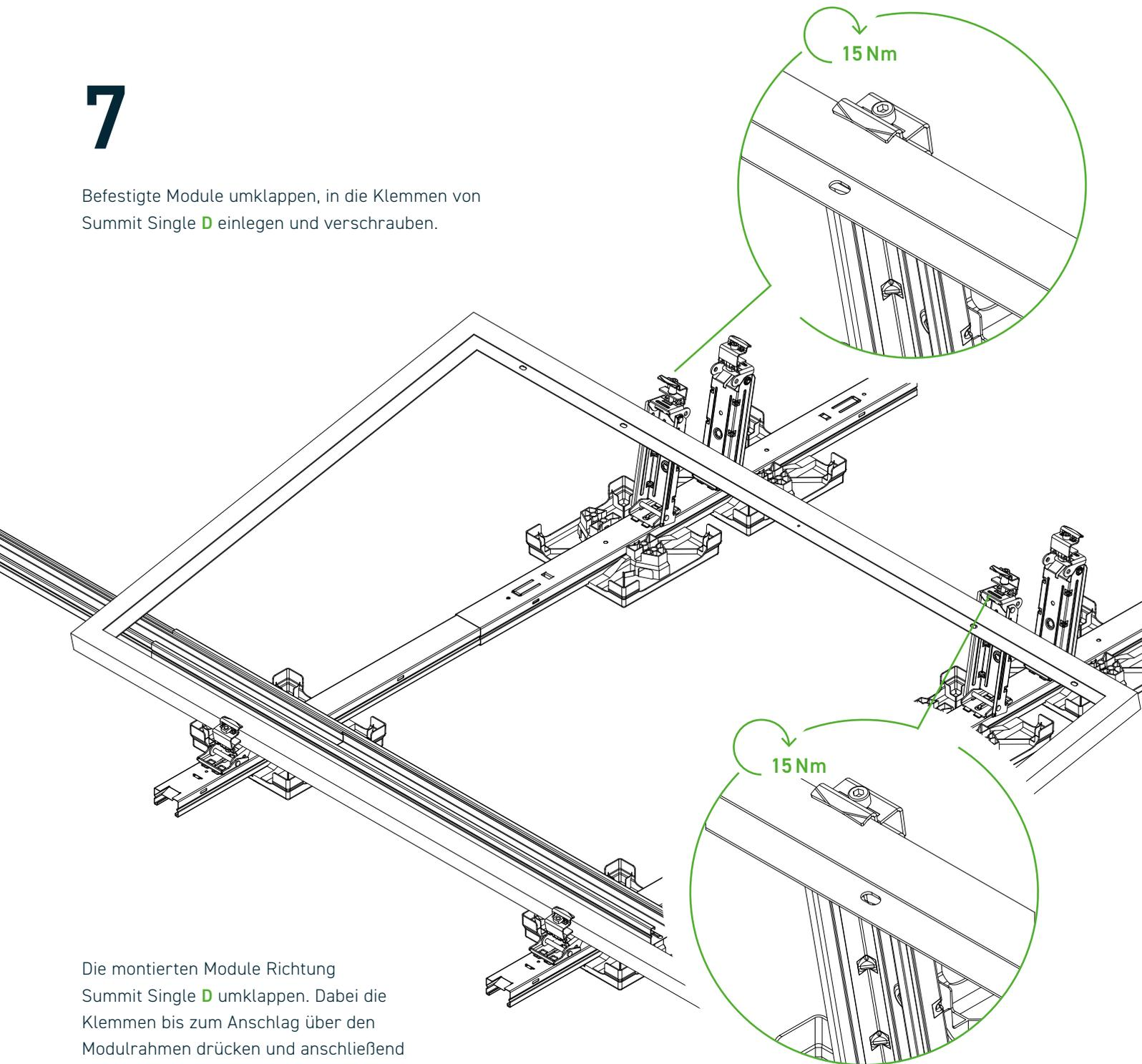
Die montierten Module Richtung Summit Single **D** umklappen. Dabei die Klemmen bis zum Anschlag über den Modulrahmen drücken und anschließend verschrauben. Dabei auf die richtige Positionierung und einen festen Sitz prüfen.
