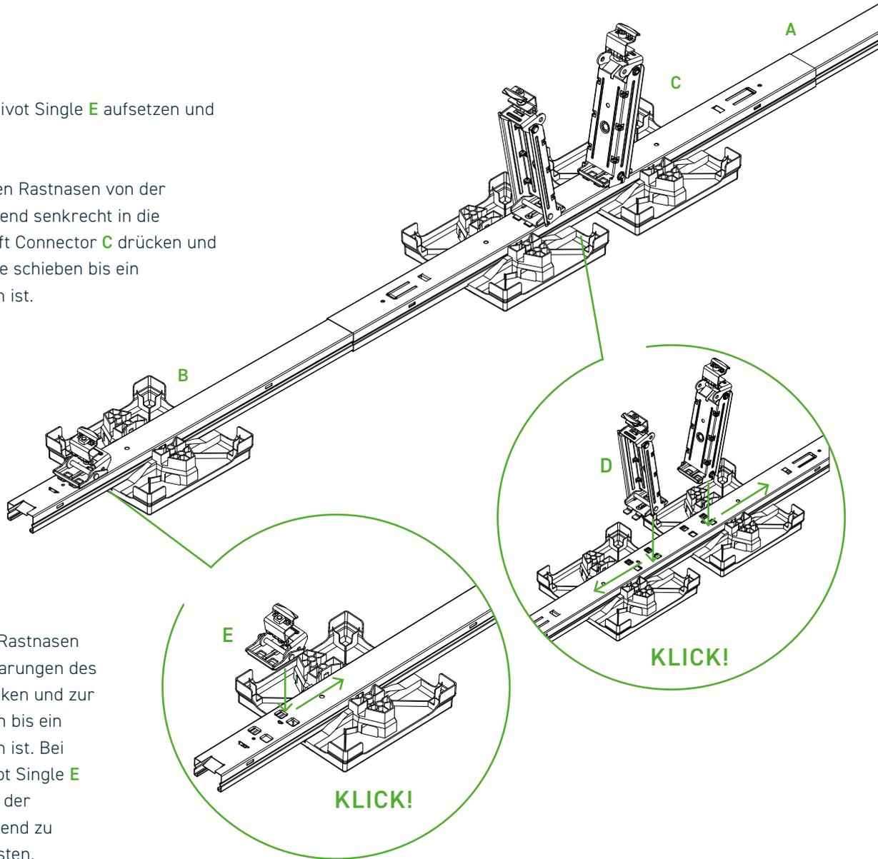
Pivot Single **E** mit den Rastnasen senkrecht in die Aussparungen des Swift Rail Short **B** drücken und zur Schienenmitte schieben bis ein Klickgeräusch zu hören ist. Bei Swift Rail **A** ist der Pivot Single **E** mit den Rastnasen von der Schienenmitte wegzeigend zu platzieren und einzurasten.
