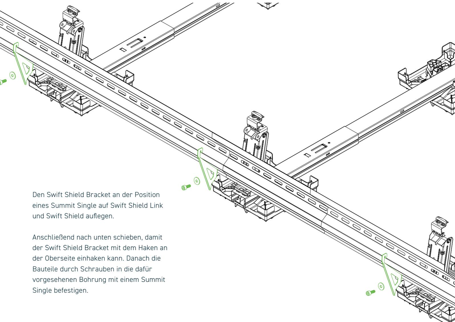
Den Swift Shield Bracket an der Position eines Summit Single auf Swift Shield Link und Swift Shield auflegen.
