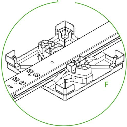
Bereits verrastete Swift Rail Short **B** mit Swift Rail Connector **C** und Swift Rail **A** auf die EasyPlates **F** auflegen und an den vorgesehenen Ausschnitten verrasten. Die EasyPlates **F** können auch parallel zur Montage der einzelnen Swift Komponenten platziert werden.
