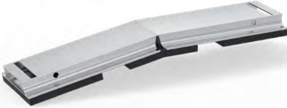
El conector de cumbrera de los perfiles de base principal se utiliza para conectar el sistema con la cumbrera. El montaje se realiza haciendo clic en la base, en el lado de la cumbrera correspondiente. En general, se recomienda el uso del conector de cumbrera o de sistemas de seguridad alternativos al modificarse la inclinación con un punto alto.
