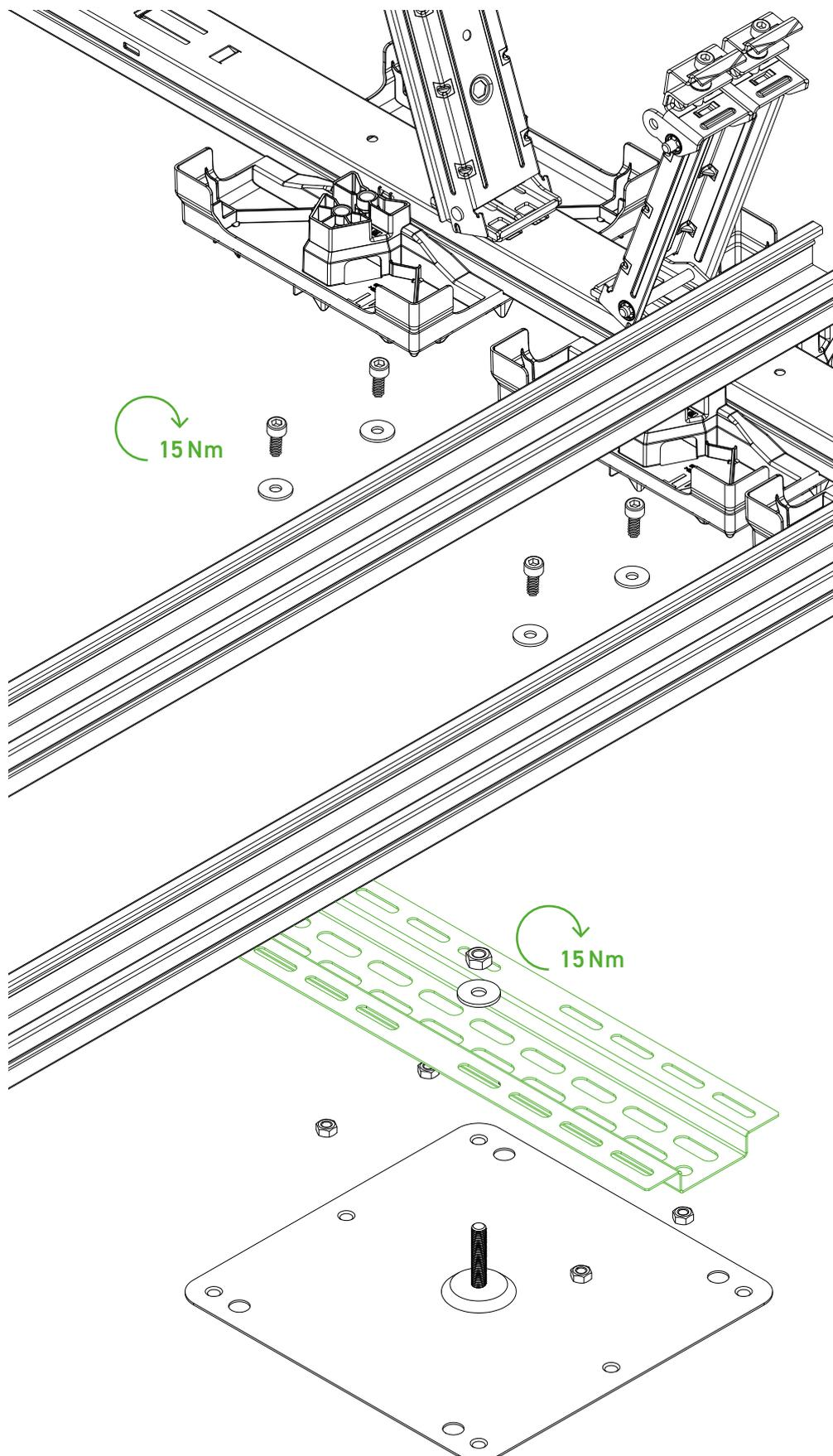
Die Befestigungspunkte der Stud Link-Anbindung befinden sich am Row Connector Edge oder Row Link Edge und sollten vor der Montage des Stud Link montiert sein. Die Befestigung der Stud Link-Anbindung sollte möglichst nah an einer Schiene erfolgen.
