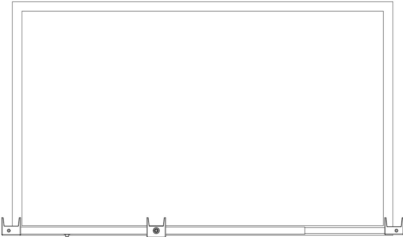
Zur Bestimmung der Modullänge die Abstandslehre drehen, mit den beiden äußeren Abstandsrippen an den Modulrahmen anlegen und mit der Feststellschraube festziehen.
