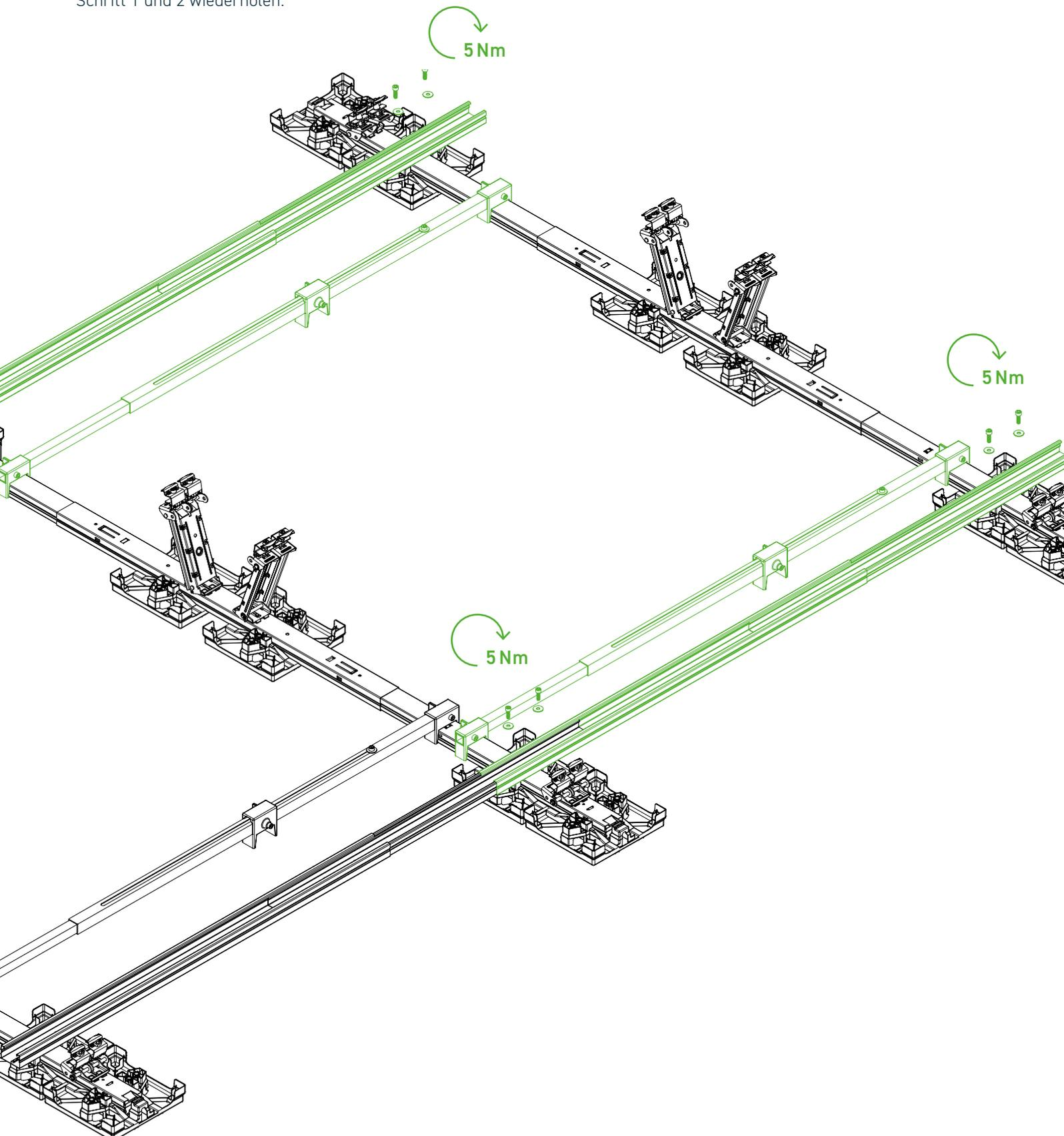
Abstandslehren von zweiter Schiene erst nach Verschraubung des Row Links entfernen.
