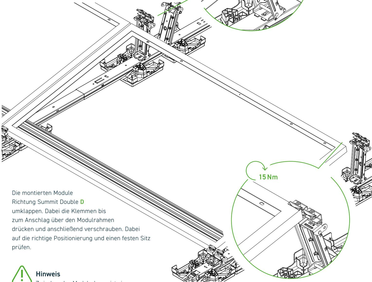
Die montierten Module Richtung Summit Double **D** umklappen. Dabei die Klemmen bis zum Anschlag über den Modulrahmen drücken und anschließend verschrauben. Dabei auf die richtige Positionierung und einen festen Sitz prüfen.
