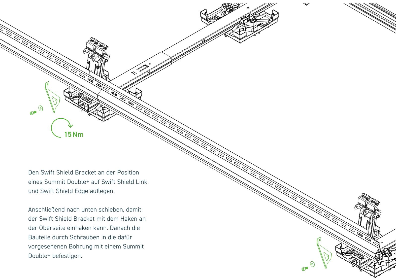
Den Swift Shield Bracket an der Position eines Summit Double+ auf Swift Shield Link und Swift Shield Edge auflegen.
