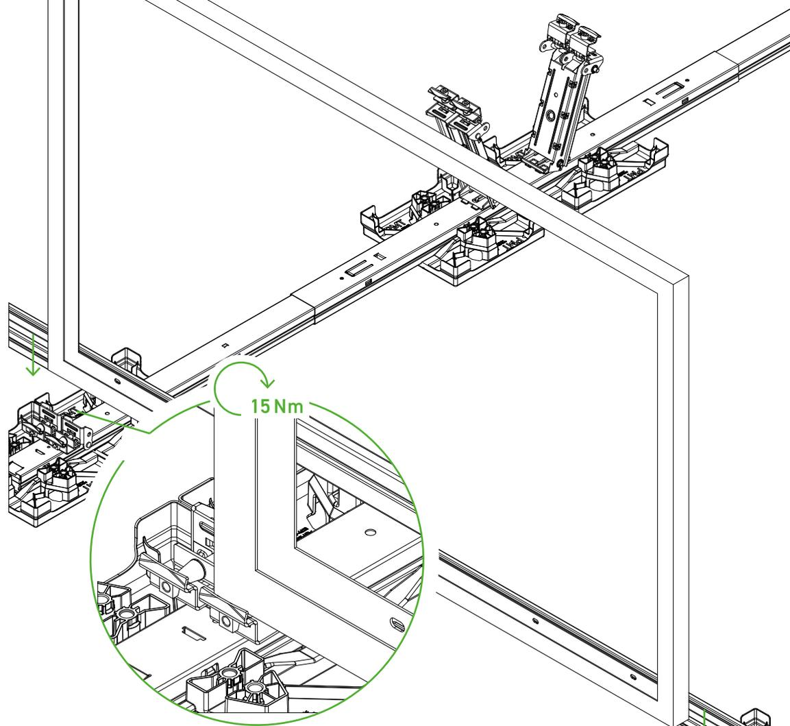
Pivot Double **E** in vertikale Position bringen und das Modul von oben in die Klemmen einlegen. Anschließend von hinten verschrauben und dabei auf festen Sitz und richtige Position überprüfen.
