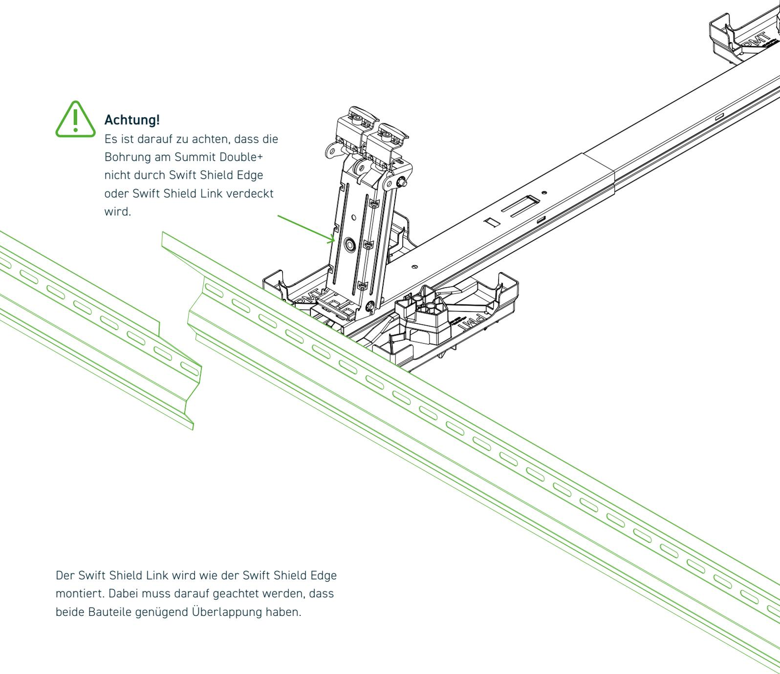
Der Swift Shield Link wird wie der Swift Shield Edge montiert. Dabei muss darauf geachtet werden, dass beide Bauteile genügend Überlappung haben.
