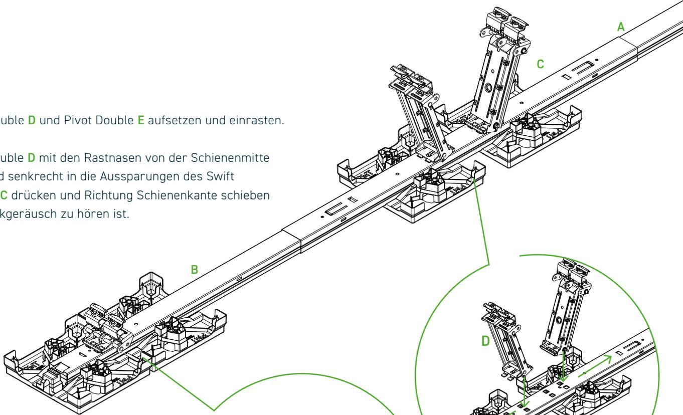
Pivot Double **E** mit den Rastnasen senkrecht in die Aussparungen des Swift Rail Short **B** drücken und zur Schienenmitte schieben bis ein Klickgeräusch zu hören ist. Bei Swift Rail **A** ist der Pivot Double **E** mit den Rastnasen von der Schienenmitte wegzeigend zu platzieren und einzurasten.
