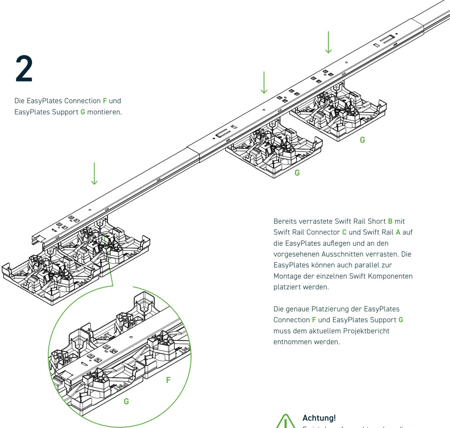
Bereits verrastete Swift Rail Short **B** mit Swift Rail Connector **C** und Swift Rail **A** auf die EasyPlates auflegen und an den vorgesehenen Ausschnitten verrasten. Die EasyPlates können auch parallel zur Montage der einzelnen Swift Komponenten platziert werden.
