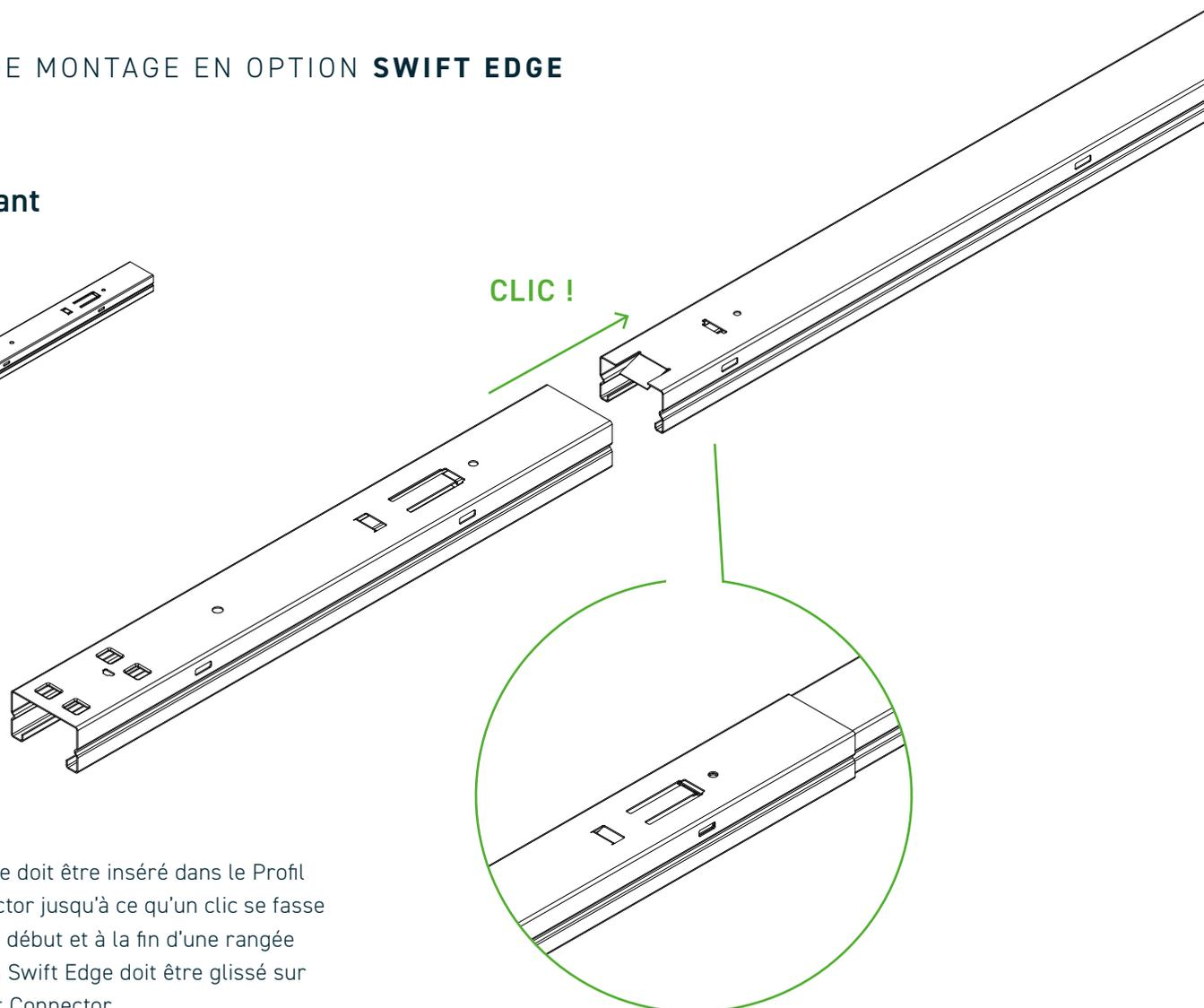
Le Swift Edge doit être inséré dans le Profil Swift Connector jusqu'à ce qu'un clic se fasse entendre. Au début et à la fin d'une rangée complète, un Swift Edge doit être glissé sur chaque Swift Connector.
