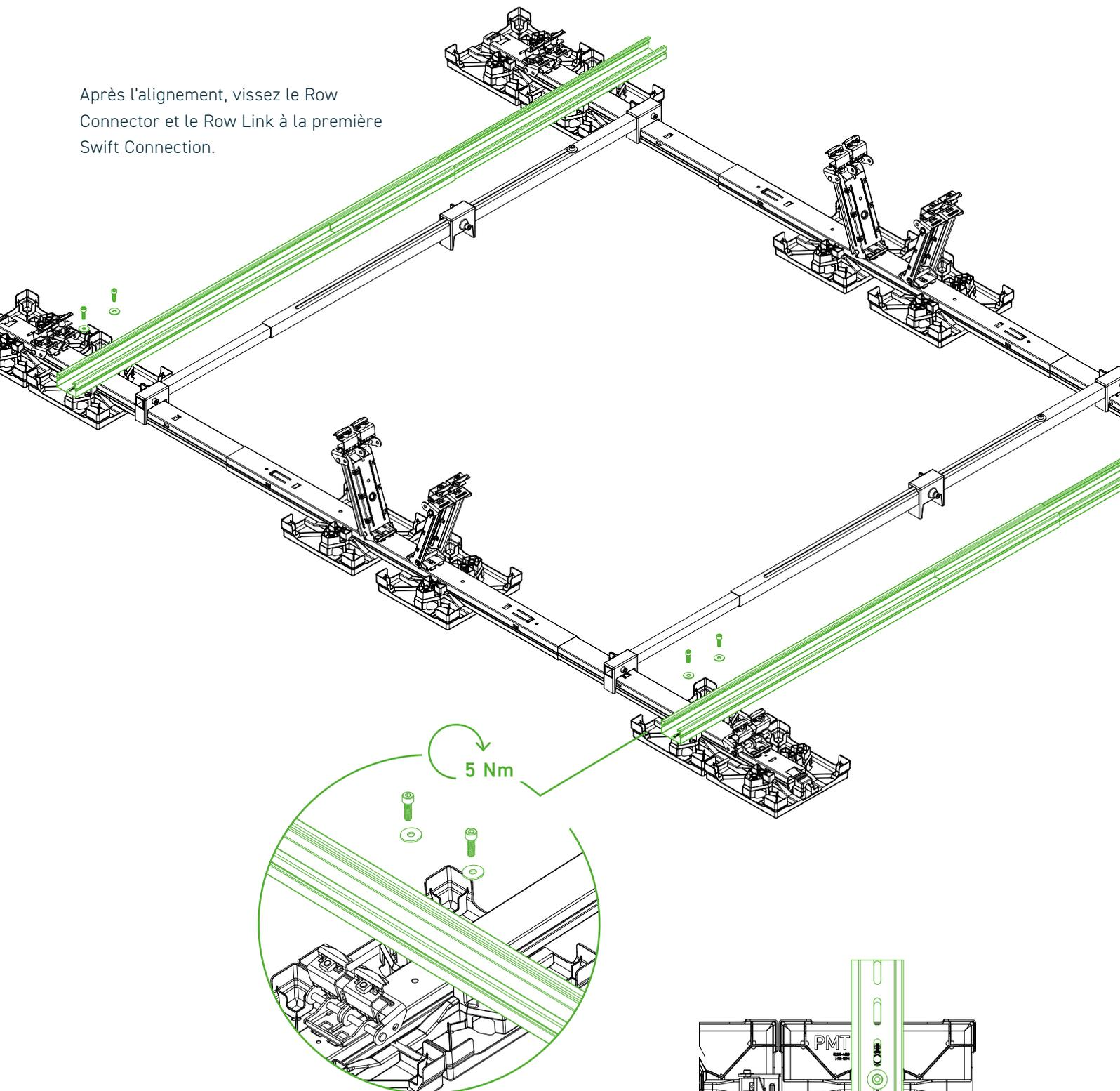
Le Row Connector Edge **I**, le Row Link Edge **J** et l'EasyPlate Connection **F** doivent impérativement être montés aux emplacements indiqués dans le rapport de projet.
