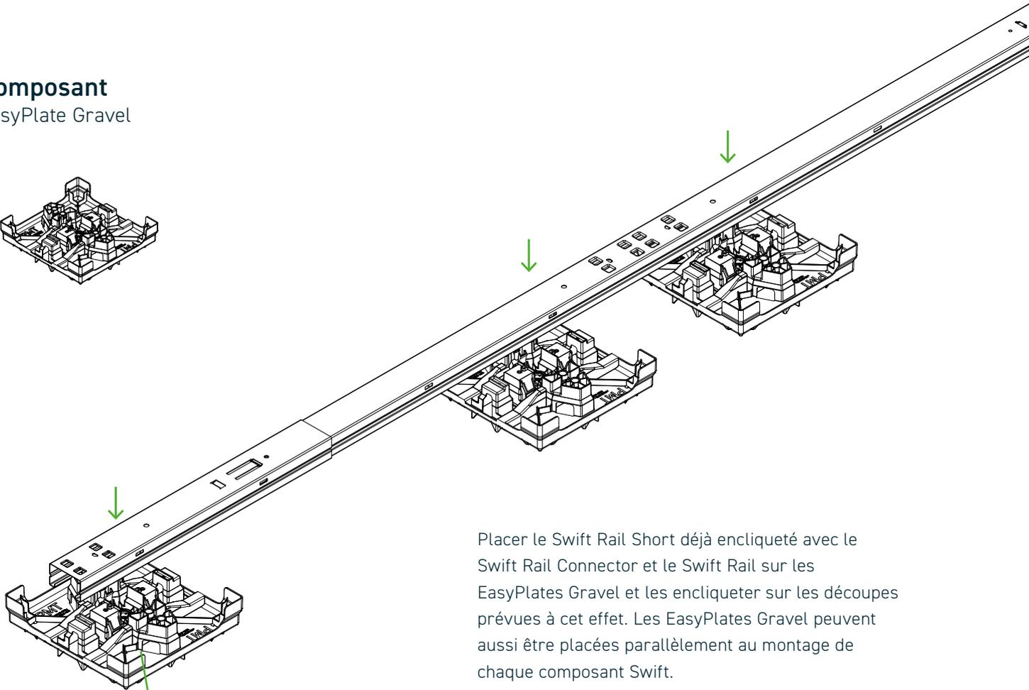
Placer le Swift Rail Short déjà encliqueté avec le Swift Rail Connector et le Swift Rail sur les EasyPlates Gravel et les encliqueter sur les découpes prévues à cet effet. Les EasyPlates Gravel peuvent aussi être placées parallèlement au montage de chaque composant Swift.
