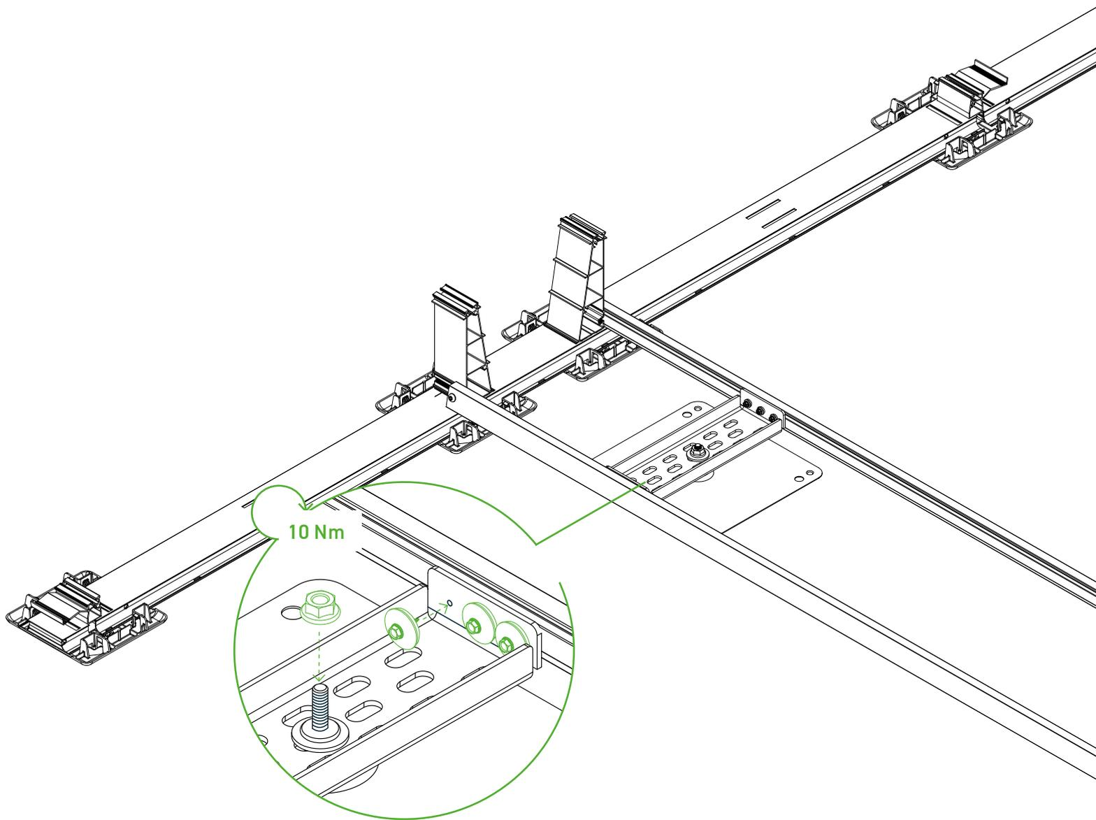
Pour consolider le point de fixation au système, visser les trois vis autoforeuses fournies de chaque côté à travers la tôle USO dans les entretoises de jonction et de lestage. Pour connaître la position de la fixation USO, il faut toujours se référer aux documents actuels du projet.
