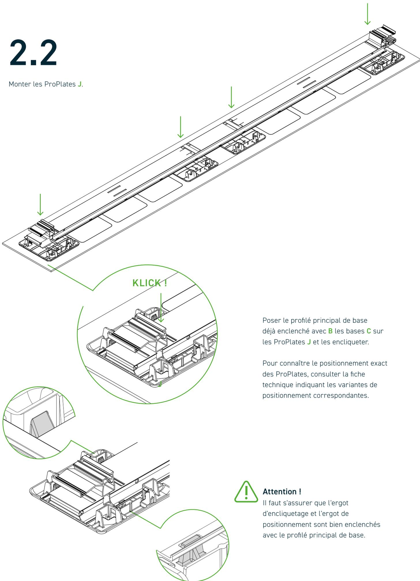
Poser le profilé principal de base déjà enclenché avec **B** les bases **C** sur les ProPlates **J** et les encliquer.
