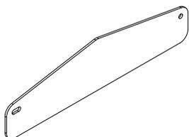
L'appui intermédiaire offre un soutien supplémentaire en cas de charges de neige élevées, de grands panneaux et pour réduire la charge exercée sur l'isolation. Ce composant se monte sur la Tower à l'aide de deux vis. Ceux-ci sont vissés dans les trous découpés au laser de l'appui intermédiaire dans les encoches de la Tower. Pour connaître la position exacte des appuis intermédiaires, consulter les documents actuels du projet.
