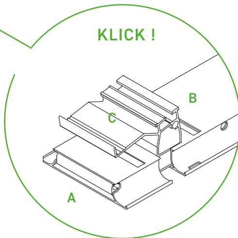
La base **C** doit être glissée dans le profilé principal de base **B** jusqu'à entendre le clic d'enclenchement. Il faut monter deux bases par profilé principal de base. Au début et à la fin d'un profilé principal de base, il faut aussi monter un embout de départ & fin **A** sur la base **C**.
