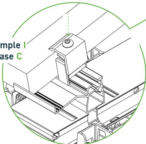
Placer les bride double et bride simple **I** sur le côté de la base **C** qui est orienté vers la Tower **E** dans la rainure de guidage supérieure et les pousser dans la rainure de guidage opposée jusqu'à ce qu'elles s'enclenchent de manière audible. Veiller à ce que les bride double et bride simple **I** soient bien fixées et à fleur dans les rainures de guidage.
