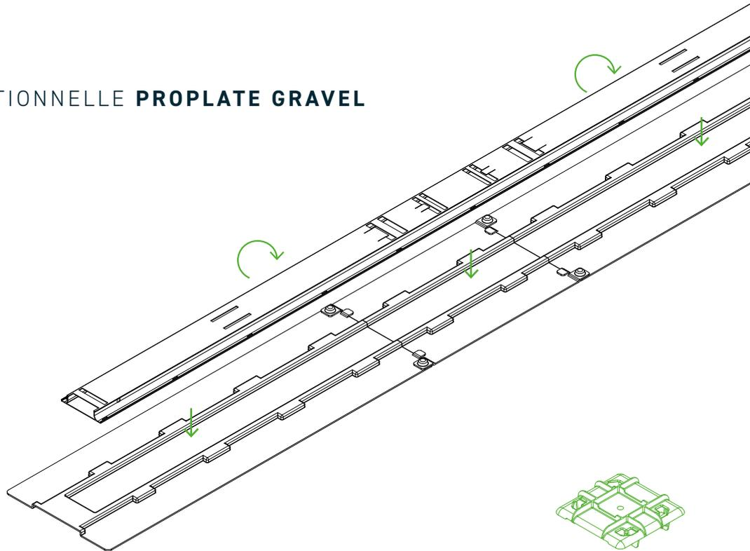
Retourner le profilé principal de base et le placer à l'envers dans le ClickGuide ReUse. Poser ensuite les ProPlates Gravel et les encliquer. Pour connaître le positionnement exact des ProPlates Gravel, consulter la fiche technique indiquant les variantes de positionnement correspondantes.
