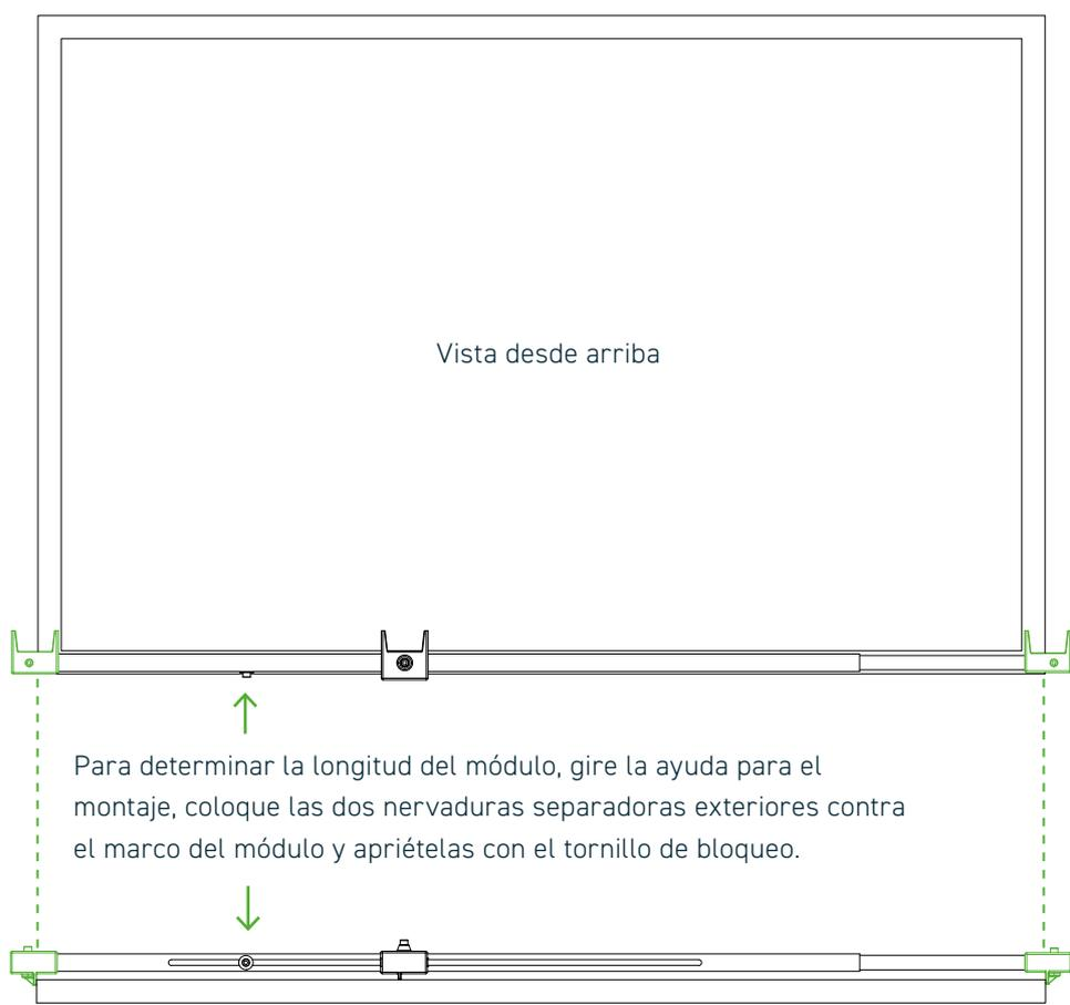
Para determinar la longitud del módulo, gire la ayuda para el montaje, coloque las dos nervaduras separadoras exteriores contra el marco del módulo y apriételas con el tornillo de bloqueo.
