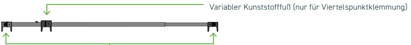
Äußere Kunststofffüße zur Ausrichtung für Randklemmung
