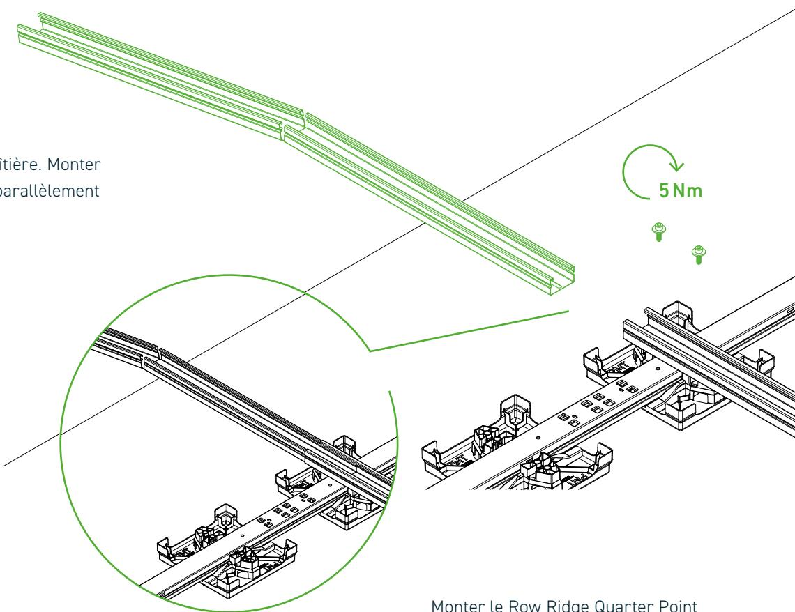
Monter le Row Ridge Quarter Point à la place d'un Row Link. Réaliser le montage de manière homogène des deux côtés pour éviter une charge unilatérale et un glissement. Toujours vérifier la position exacte des raccordements de faîtiage dans la documentation actuelle du projet.
