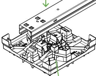
Placer le Swift Rail Short déjà encliqueté avec le Swift Rail Connector et le Swift Rail sur les EasyPlates Gravel et les encliquer sur les découpes prévues à cet effet. Les EasyPlates Gravel peuvent aussi être placées parallèlement au montage de chaque composant Swift.
