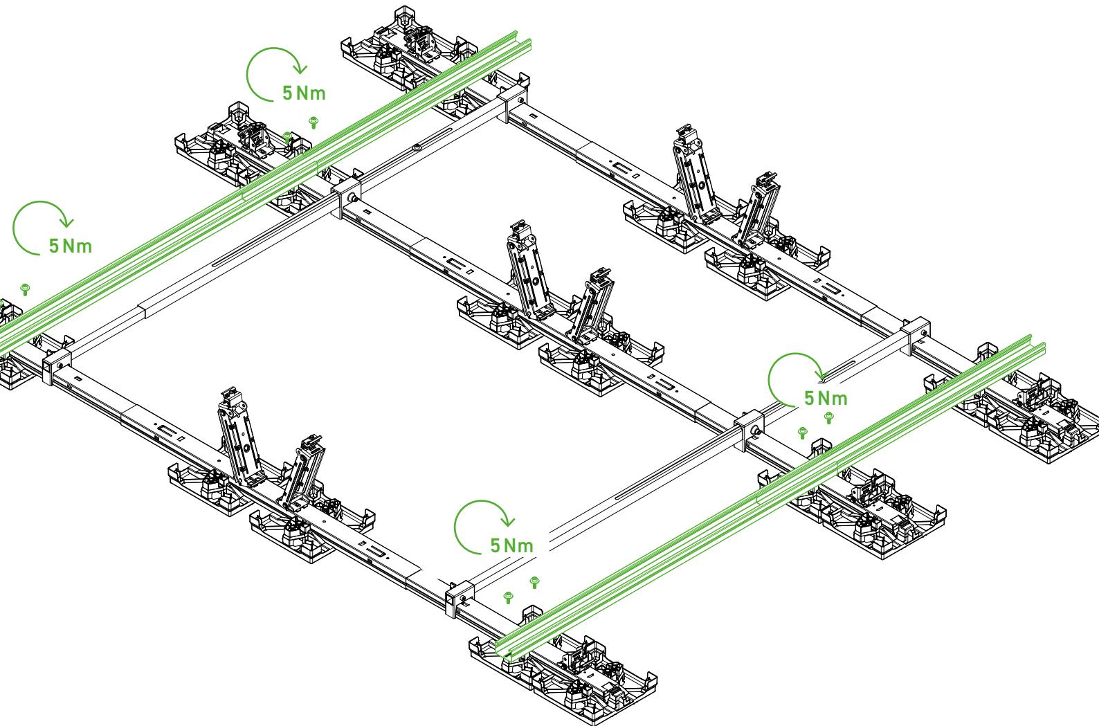
Le Row Connector Edge **I**, le Row Link Edge **J** et l'EasyPlate Connection **F** doivent impérativement être montés aux emplacements indiqués dans le rapport de projet.
