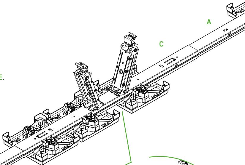
Appuyer le Pivot Single **E** avec les taquets à la verticale dans les espaces du Swift Rail Short **B** et pousser vers le milieu du rail jusqu'à ce qu'un clic se fasse entendre. Pour le Swift Rail **A**, placer et encliquer le Pivot Single **E** avec les taquets dans le sens opposé au milieu du rail.
