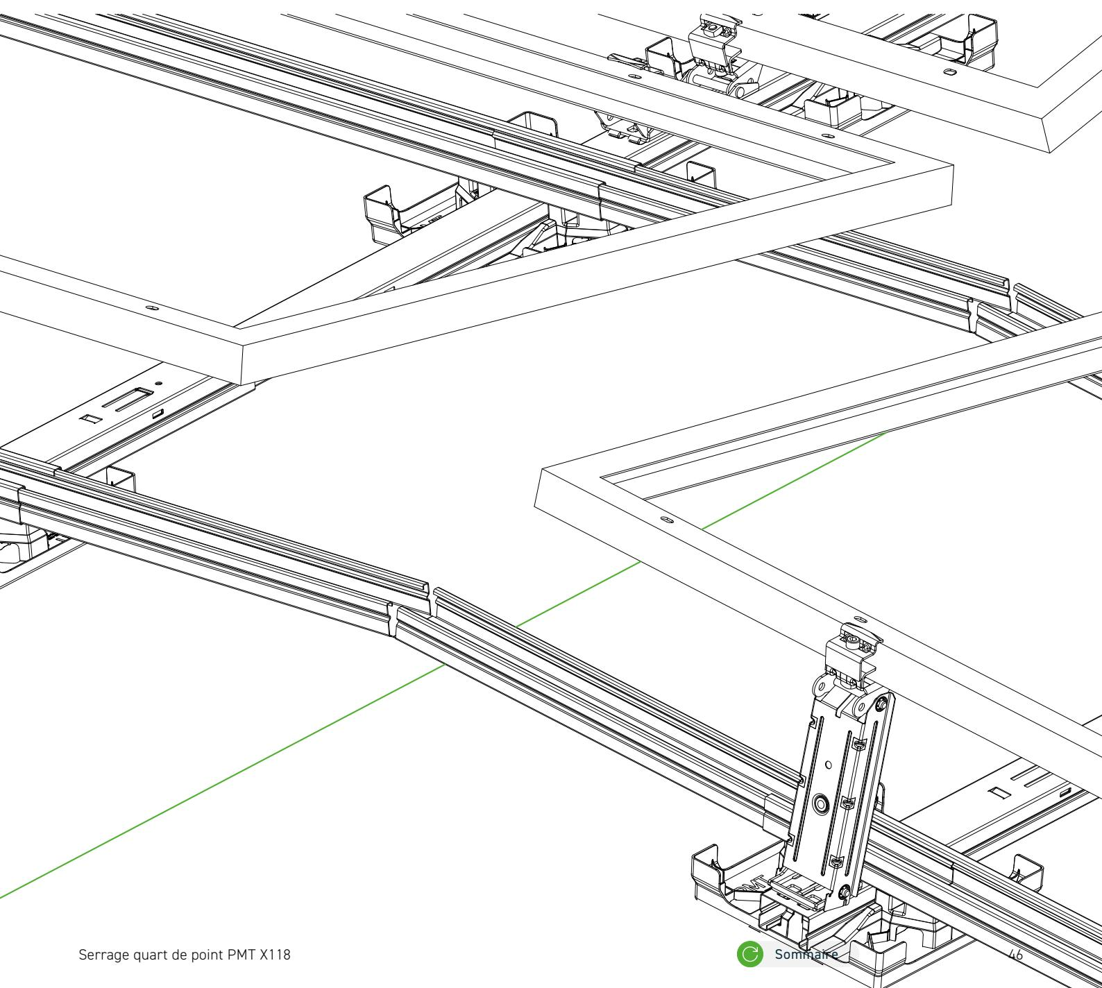
Déterminer d'abord la ligne faîtière. Monter ensuite les profils Swift Rail (parallèlement au faîte).
