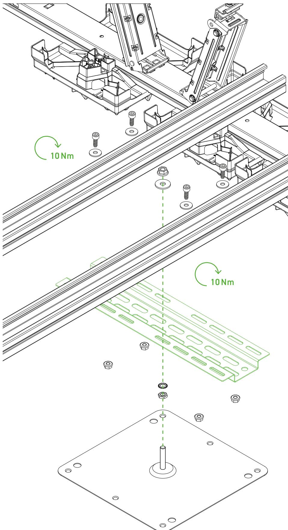
Les points de fixation du raccordement du Stud Link se trouvent sur le Row Connector ou le Row Link et doivent être montés avant le montage du Stud Link. La connexion Stud Link doit être fixée à une distance minimale de 150 mm et maximale de 400 mm à côté d'un rail.
