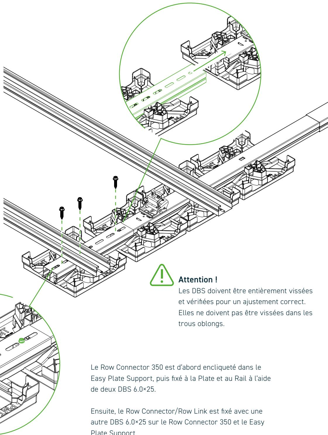
Le Row Connector 350 est d'abord encliqueté dans le Easy Plate Support, puis fixé à la Plate et au Rail à l'aide de deux DBS 6.0×25.
