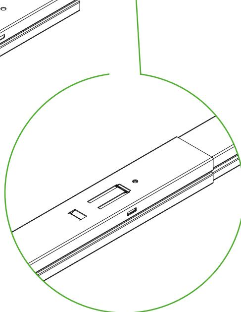
Insérer le Swift Edge dans le Profil Swift Connector jusqu'à ce qu'un clic se fasse entendre. Au début et à la fin d'une rangée complète, glisser un Swift Edge sur chaque Swift Connector.
