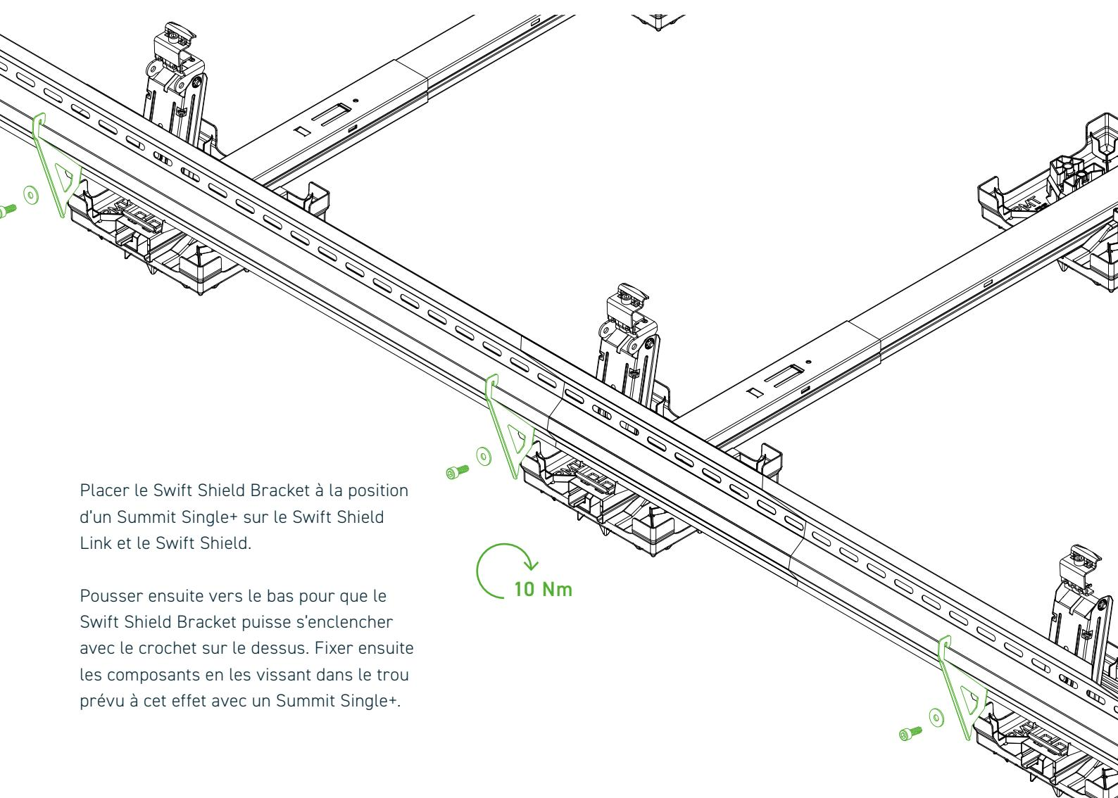
Placer le Swift Shield Bracket à la position d'un Summit Single+ sur le Swift Shield Link et le Swift Shield.
