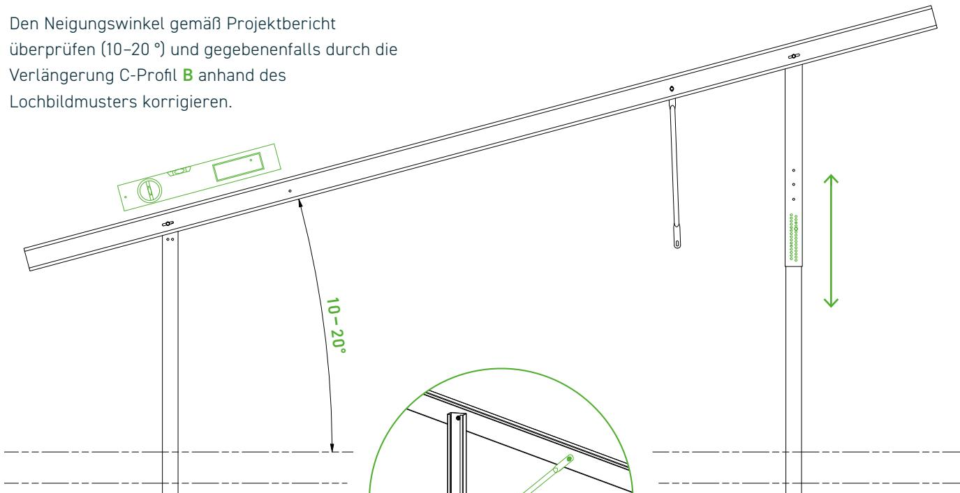
Die Diagonale **C** an Sparren **D** und Verlängerung C-Profil **B** mit 90 – 100 Nm verschrauben.
