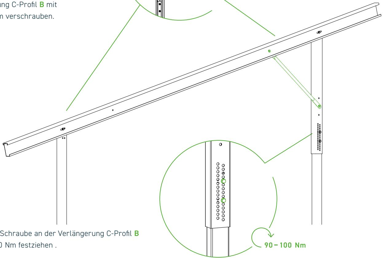
Die zweite Schraube an der Verlängerung C-Profil **B** mit 90 – 100 Nm festziehen .
