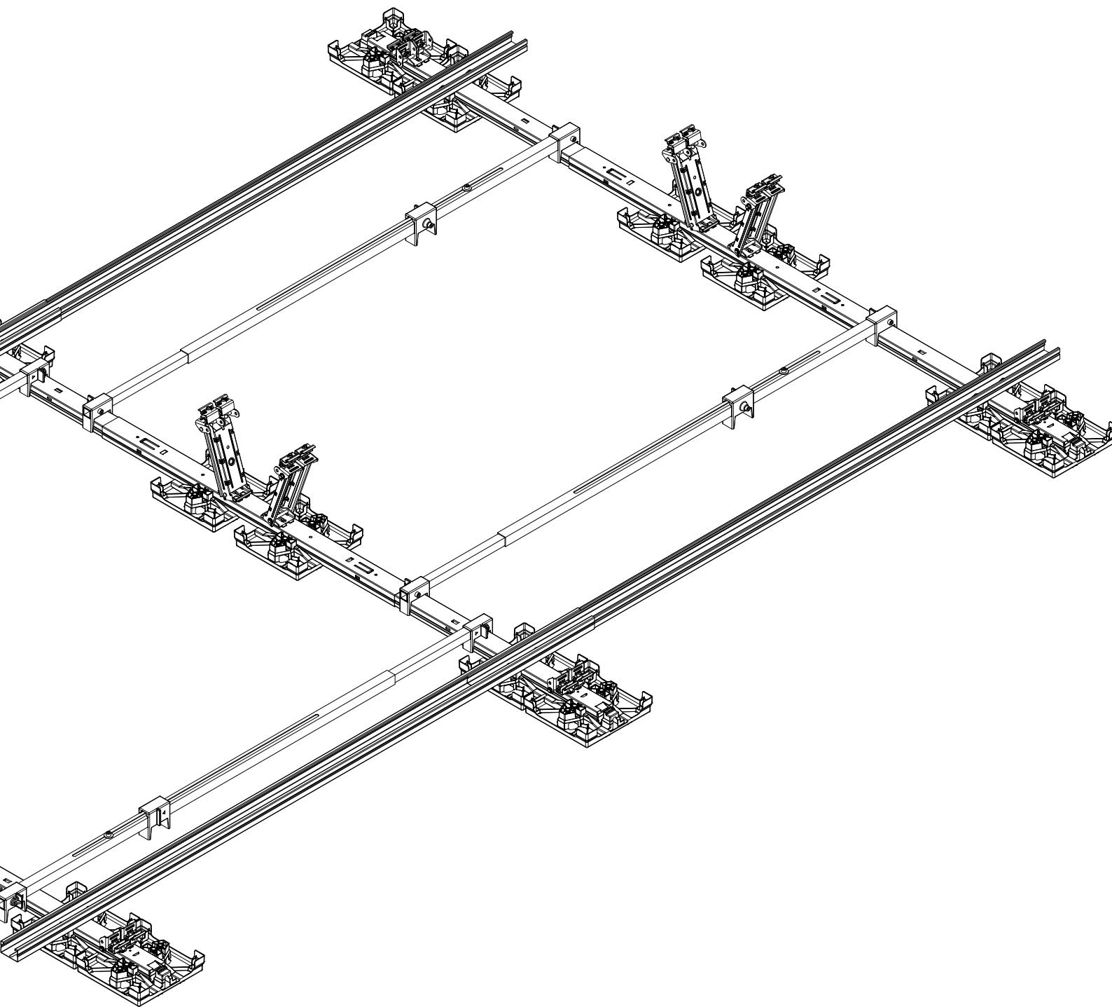
Montagehilfen von zweiter Schiene erst nach Verschraubung des Row Links entfernen.
