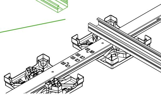
Anstelle eines Row Link wird der Row Ridge eingebaut. Der Aufbau sollte gleichmäßig nach beiden Seiten erfolgen, um eine einseitige Belastung und somit ein Verrutschen zu verhindern. Die Lage und Position der Firstverbinder ist immer den aktuellen Projektunterlagen zu entnehmen.
