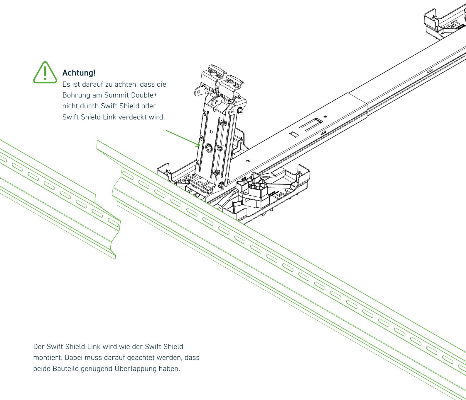
Der Swift Shield Link wird wie der Swift Shield montiert. Dabei muss darauf geachtet werden, dass beide Bauteile genügend Überlappung haben.
