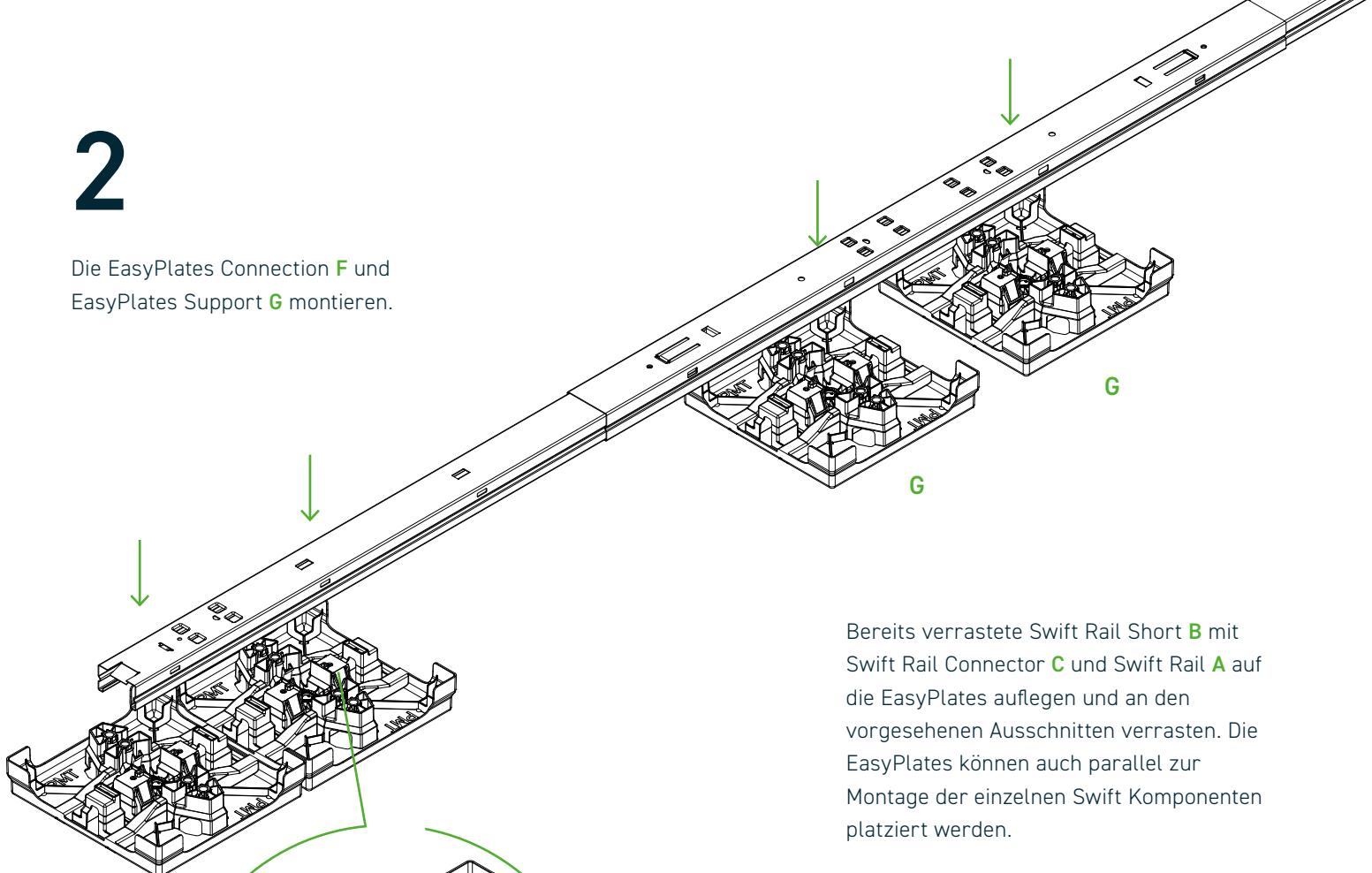
Bereits verrastete Swift Rail Short **B** mit Swift Rail Connector **C** und Swift Rail **A** auf die EasyPlates auflegen und an den vorgesehenen Ausschnitten verrastet. Die EasyPlates können auch parallel zur Montage der einzelnen Swift Komponenten platziert werden.
