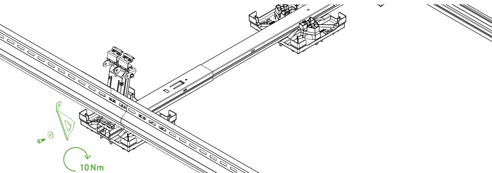
Den Swift Shield Bracket an der Position eines Summit Double+ auf Swift Shield Link und Swift Shield auflegen.
