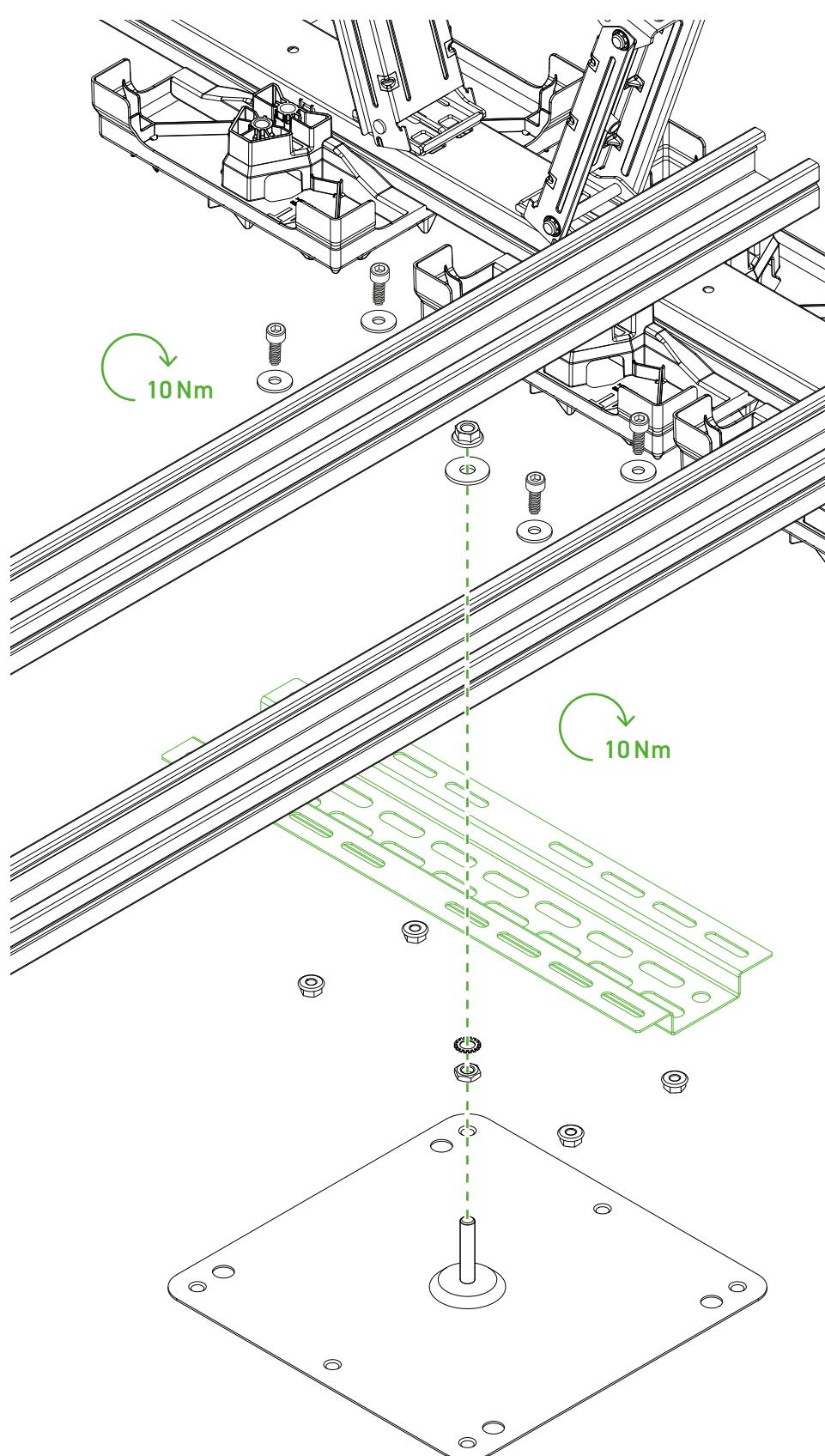
Die Befestigungspunkte der Stud Link-Anbindung befinden sich am Row Connector Edge oder Row Link Edge und sollten vor der Montage des Stud Link montiert sein. Die Stud Link-Anbindung ist mit einem Abstand von mindestens 150 mm und maximal 400 mm neben einer Schiene zu befestigen.
