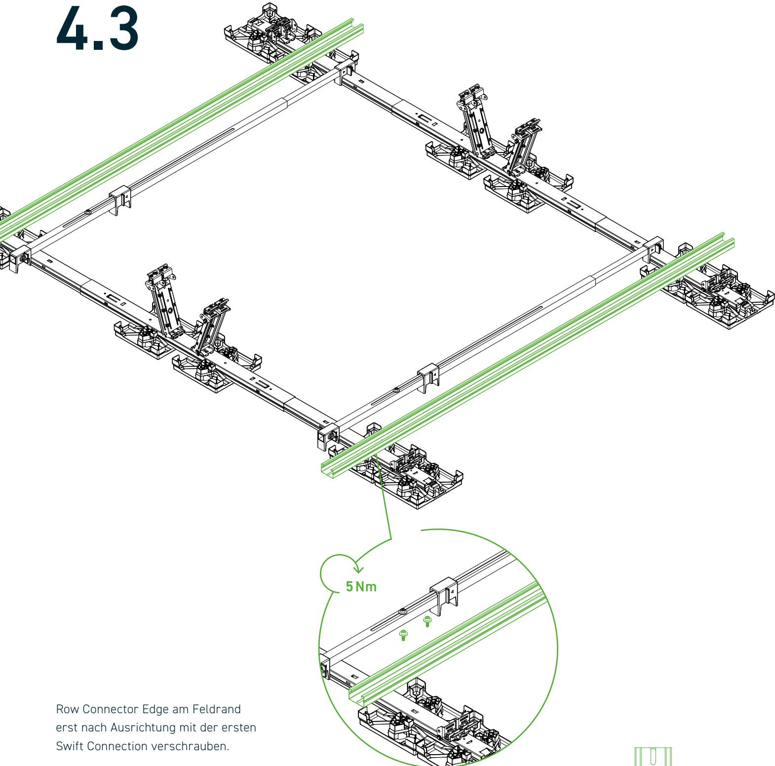
Row Connector Edge **I**, Row Link Edge **J** und EasyPlate Connection **F** sind zwingend laut Projektbericht an den angegebenen Stellen zu montieren.
