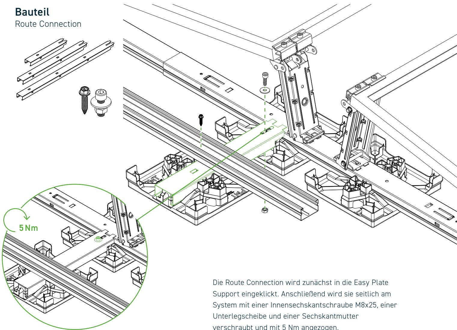
Die Route Connection wird zunächst in die Easy Plate Support eingeklickt. Anschließend wird sie seitlich am System mit einer Innensechskantschraube M8x25, einer Unterlegscheibe und einer Sechskantmutter verschraubt und mit 5 Nm angezogen.
