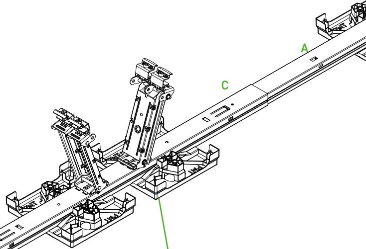
Pivot Double **E** mit den Rastnasen senkrecht in die Aussparungen des Swift Rail Short **B** drücken und zur Schienenmitte schieben bis ein Klickgeräusch zu hören ist. Bei Swift Rail **A** ist der Pivot Double **E** mit den Rastnasen von der Schienenmitte wegzeigend zu platzieren und einzurasten.
